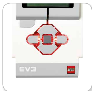
Индикатор состояния модуля – Красный
