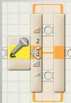
**Блок «Переключатель», блок условия (в данном случае настроен на датчик звука)**
