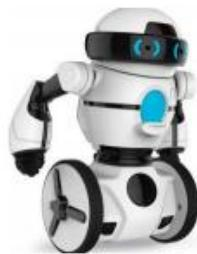
Робот движется по ровной поверхности, каждым колесом управляет отдельный двигатель.
